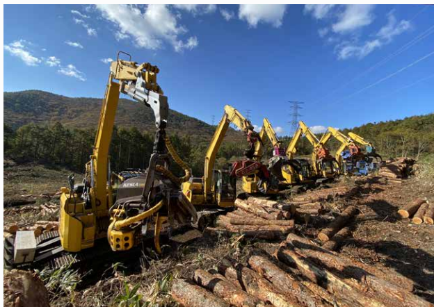
用途に応じた多様なアタッチメントを備えた重機群。カラマツ伐採にも対応できる柔軟な設備構成が強み
