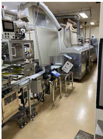
製造ライン 左から小袋貼付装置、ウェイトチェッカー、金属検出機
