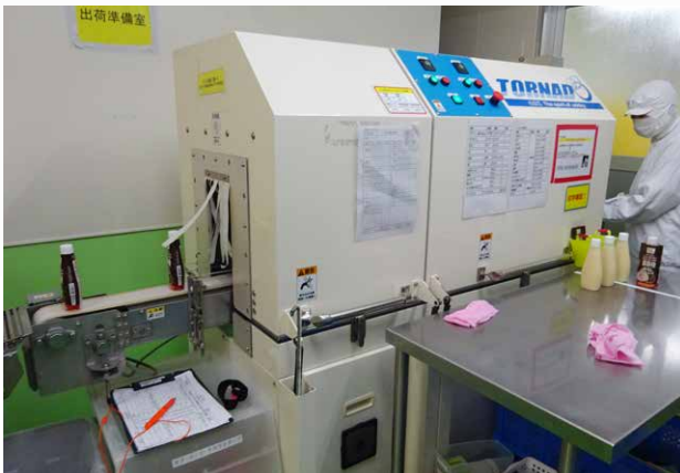
おろしにんにくを入れたチューブを包装するシュリンク装置
