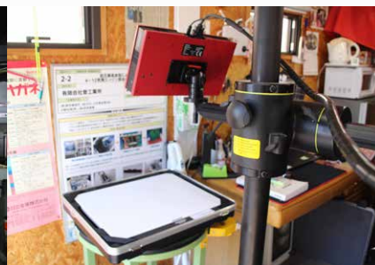
振動対策で新設したプレハブ内に設置した3D スキャナー
