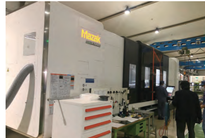
令和元年度ものづくり補助金事業で導入された5軸複合加工機
