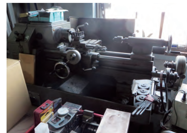
金型メンテナンスや独自治具製作に活用(汎用旋盤)
