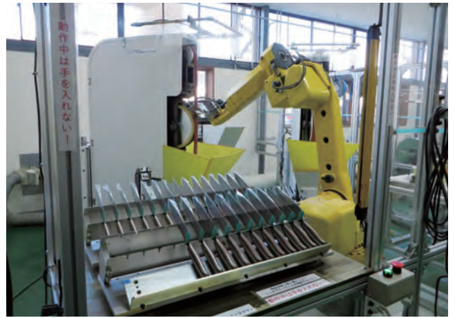
ものづくり補助金事業で導入したハンドル研磨用ロボット
