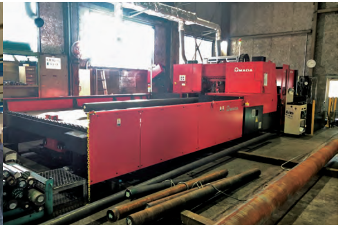
平成29年度ものづくり補助金事業で導入された全自動システムバンドソー
